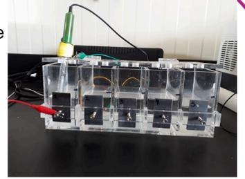
Figura 4( Celda electroquímica)
