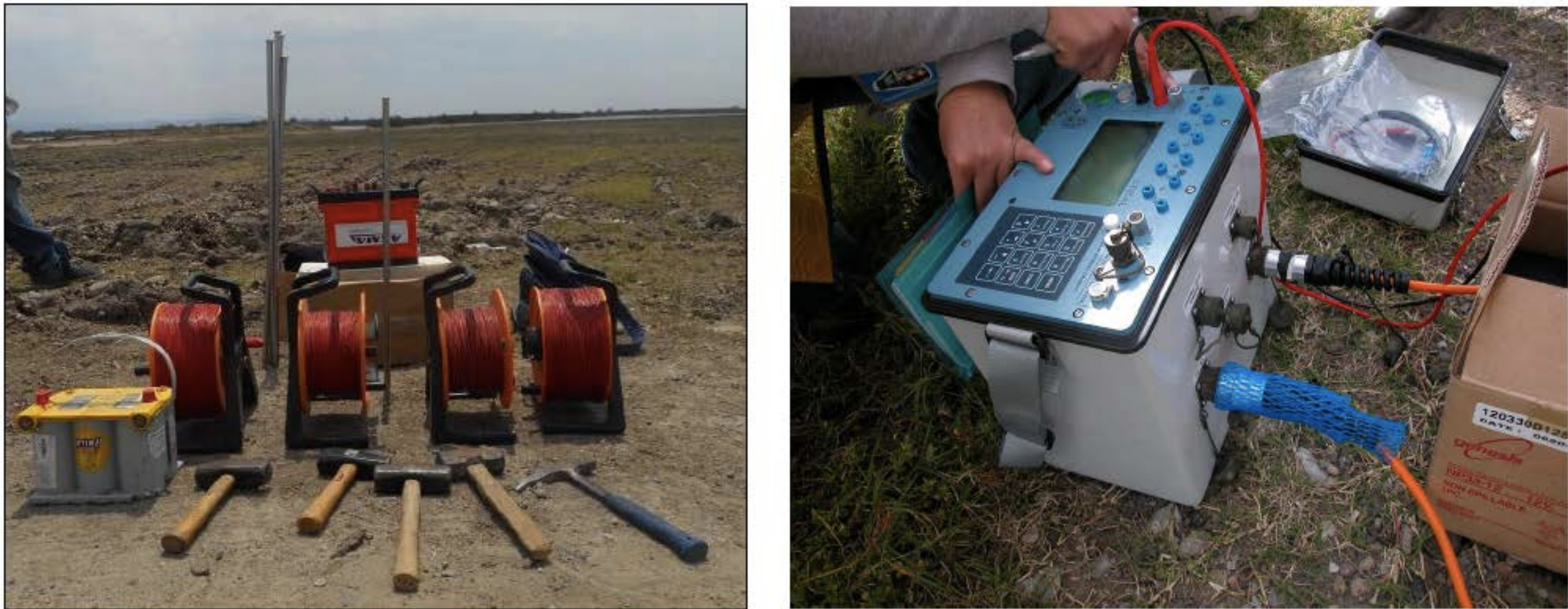
Figura 2. Equipo utilizado en campo (Sondeo eléctrico y tomografía eléctrica)
